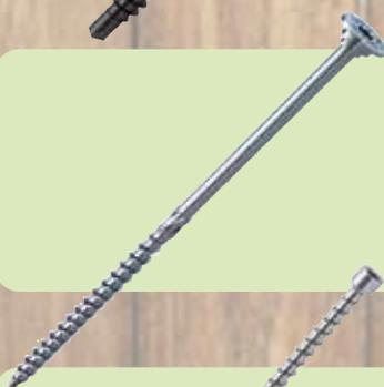
Vis de structure, charpente et sarking. Tête à double épaulement pour un affleurement parfait et une reprise de charge supérieure aux têtes rondelles. Galvanisé du  $\varnothing$  4 -5 mm et Zingué du  $\varnothing$  6-10 mm. Homologation en pose « sarking » (Isolation sur toiture). Normée sismique et utilisable avec les boulonneuses à choc. Livré avec embout et crayon de charpentier.
